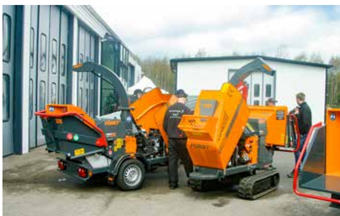
Flishuggar av märket Först tillverkas i olika storlekar, för bilsläp, traktorburna eller på larvfötter. De drivs av dieselmotorer från Kubota. Trädstammar upp till 20 cm i diameter kan matas in och förvandlas till lätthanterlig flis.
