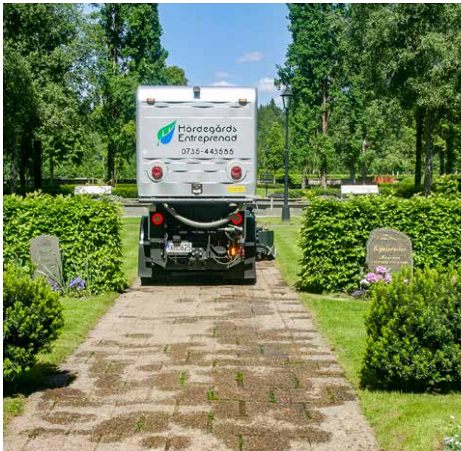
Maskinen tar sig lätt fram även i trånga passager. Aggregatet framtill kan stängas av ned till en fjärdedel för att minska onödigt spill av hetvatten.
