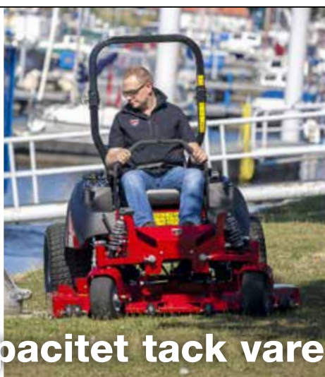
Maskinen tar sig lätt fram även i trånga passager. Aggregatet framtill kan stängas av ned till en fjärdedel för att minska onödigt spill av hetvatten.
