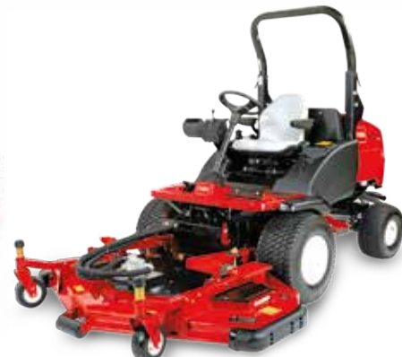
Toro Groundsmaster 3400-D Välj mellan ROPS eller demonterbar, bekväm hytt med AC. Klippbredd: 157, 183 cm
