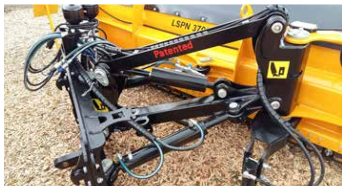
Så här ser den ut: Meirens nya patenterade parallelogramkonstruktion som förenklar och effektiviserar snöröjningen.
