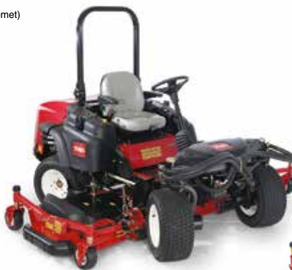
Toro Groundmaster 360-D Välj mellan ROPS eller praktisk hytt med AC. Klippbredd: 183 cm, 254 cm
