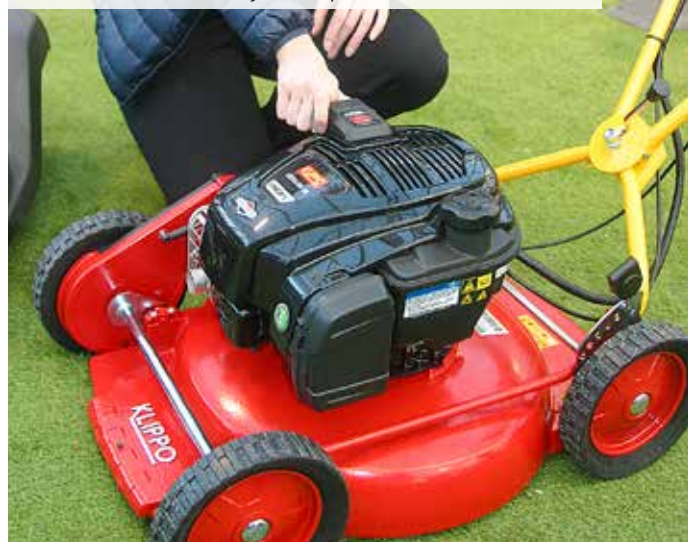
Nya Klippo Excellent SE med smidigt avtagbart startbatteri visades av Malin Nilsson Tunner. Batteriet klarar 50 starter innan det behöver laddas igen. Ett tomt batteri kan snabbaddas på ett par minuter. Det är försett med en mätare som visar hur mycket kapacitet som finns kvar.
