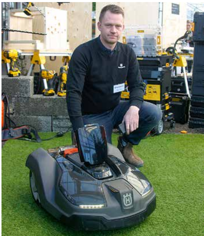
Denna nyhet, här presenterad av Niklas Broberg, är Husqvarnas mest avancerade och robusta robotgräsklippare någonsin. Husqvarna Automower 450X klarar av ytor upp till 5 000 m 2 – mer än en fotbollsplan. Bland flera innovativa funktioner kan nämnas: snabbare klippning än tidigare modeller, ultraljud som bromsar inför ett hinder och kapacitet för sluttningar upp till 45 procent lutning. Klipparen är tystgående, ljudet uppgår endast till 58 dB(A). Den är också utrustad med vädertimer som maximerar klipptiden under perioder när gräset växer mycket. Kan styras via en app och är stöldskyddad med GPS.
