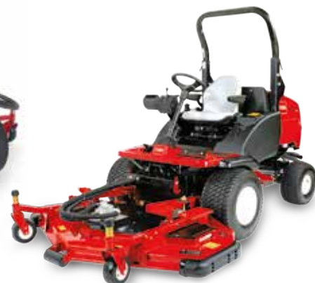
Toro Groundmaster 3400-D Välj mellan ROPS eller demonterbar, bekväm hytt med AC. Klippbredd: 157, 183 cm
