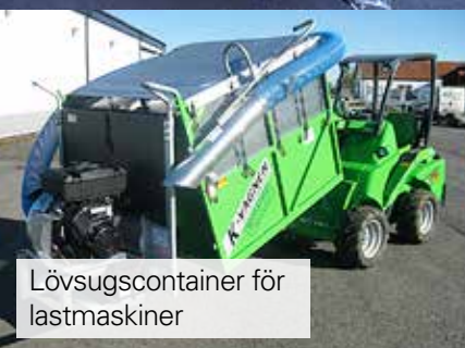
K-sugen kan monteras på alla vagnar
