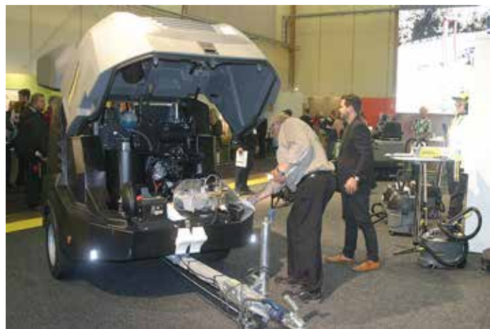
Från Kärcher kommer denna Twt trailer med integrerad vattentank på 500 liter och både hög- och lågtrycksteknik. Kan användas för bevattning, tvätt och ogräsbekämpning.
