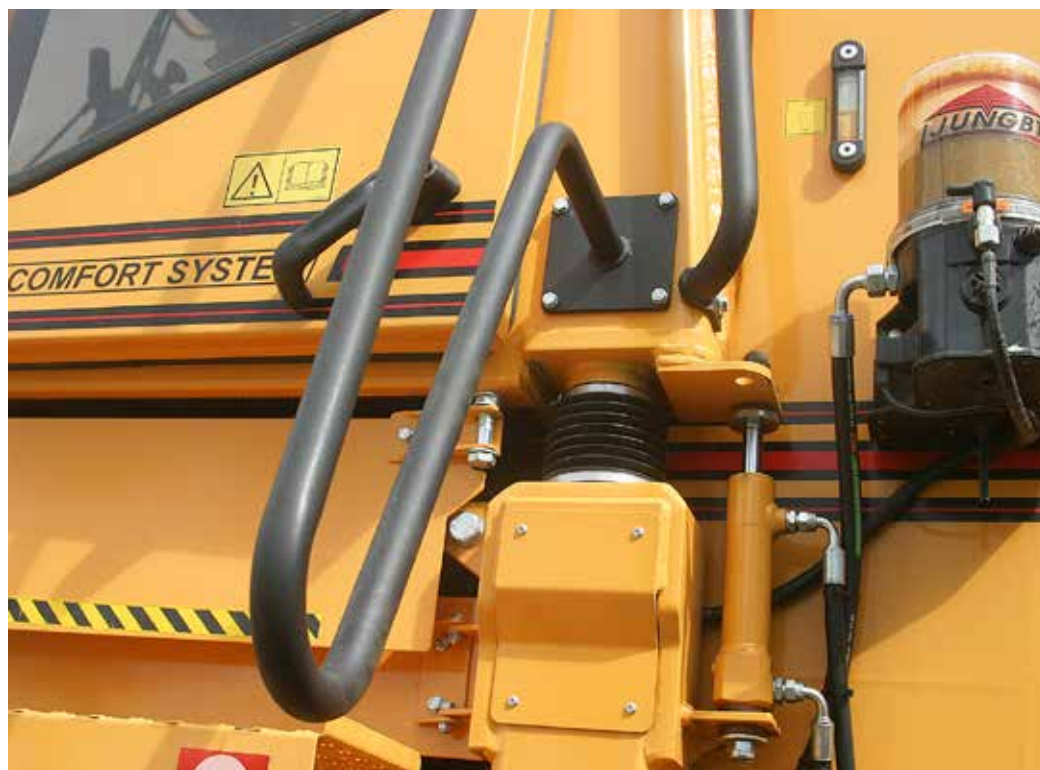
Hytten vilar på fyra hydrauliska cylindrar förbundna med gasackumulatörer. Speciella stag begränsar hyttens rörelser i alla plan så att risken för tippning elimineras.
