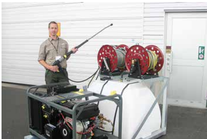
Andreas Borg, Kärcher , visar ett aggregat för ogräsbekämpning, högtryckstvätt med mera. Drivkällan är en Yanmar Diesel. Enheten kan lyftas upp på en vanlig släpkärra eller lastflak.
