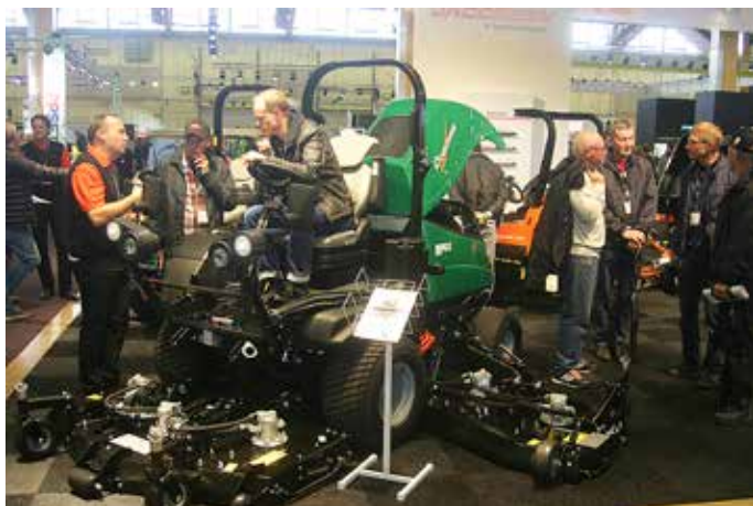
I Jacobsens monter visades flera nyheter som tilldrog sig stort intresse, bland annat den här nya rotorklipparen MP 493/653 från Ransomes . Kubotadieseln på 49 alternativt 65 hk uppfyller utsläppskraven för EU 3A respektive 3B. Klippbredder: 3-5 meter.
