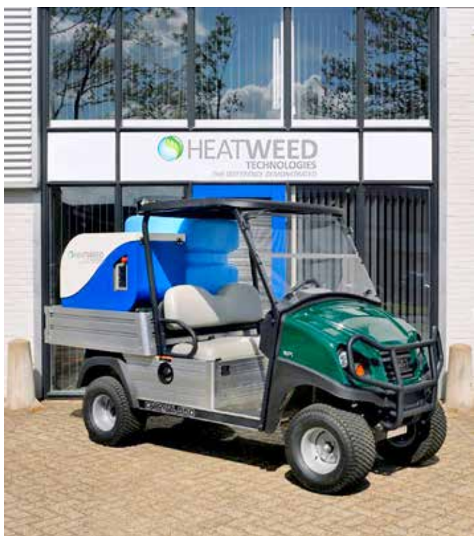
Det nya miniaggregatet från Heatweed kan transporteras på ett elbilsflak och kan då försörjas med kraft från elbilens batterier.
