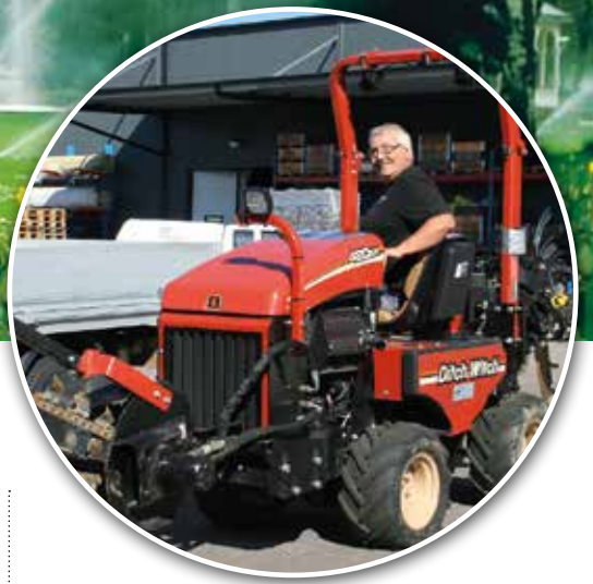
Ulf Karlsson & Ditch Witch – den optimala maskinen för plöjning av slang, med minimal påverkan på markytan.
