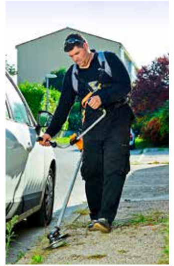
Det nya trimmerhuvudet City Cut med två motroterande knivar underlättar arbetet nära stenkanten med mera.
