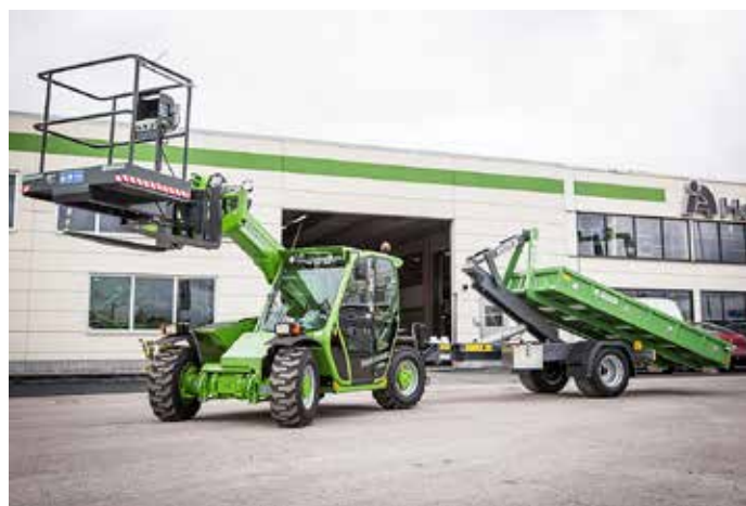
Med personkorg och flakväxlarvagn blir teleskopplastaren en användbar mångsysslare för till exempel park- och fastighetsförvaltning.
