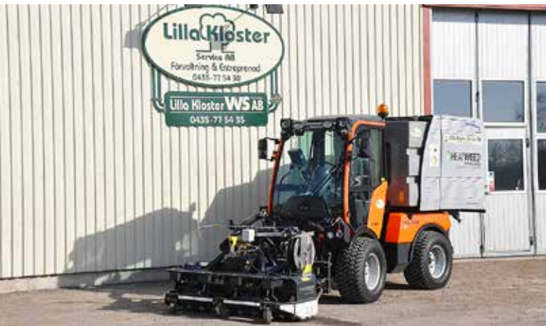
Heatweed Sensor 2 monteras på en redskapsbärare och drivs via fordonets kraftuttag.
