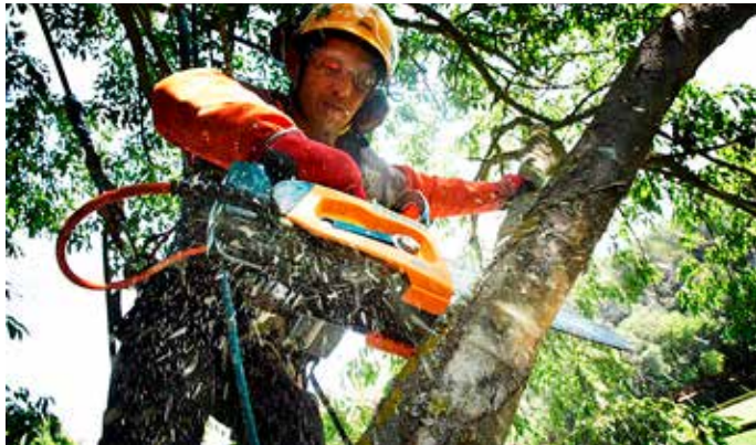
Det nya höljet på Pellencs motorsåg minskar risken för att spån och flis ska fastna.
