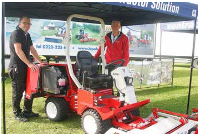
I Ventrac s monter kunde Mathias Nilsson och Anders Pettersson från Lapab Maskin visa nya uppgraderade modeller av den här välrenommerade redskapsbäraren. Bland de nya detaljerna märks motorer från Kubota, nytt elsystem, serviceluckor på sidorna, enklare montage av sandspridare m.m.
