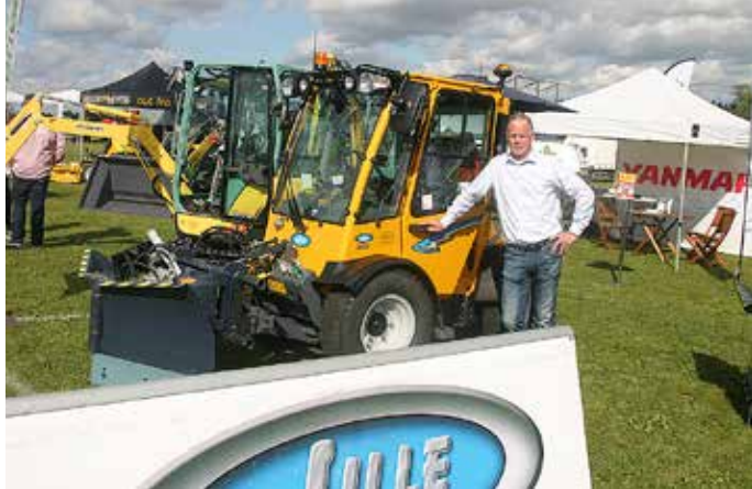
Michael Bergström på Willecenter presenterade Willes "trottoarmaskin", 120 cm bred (finns också 130 cm). Höjden underskrider 2 meter varför maskinen lämpar sig för trånga utrymmen, både på bredden och höjden.
