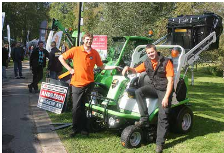
Gaetan Boyer och Magnus Selén, Stads & Parkprodukter , presenterade bland annat Etesia Hydro 124 som effektivt samlar både löv och gräsklipp. Maskinen är konstruerad utan fläkt, vilket ger ett smidigt flöde via en tunnel direkt till den högtippande uppsamlaren.
