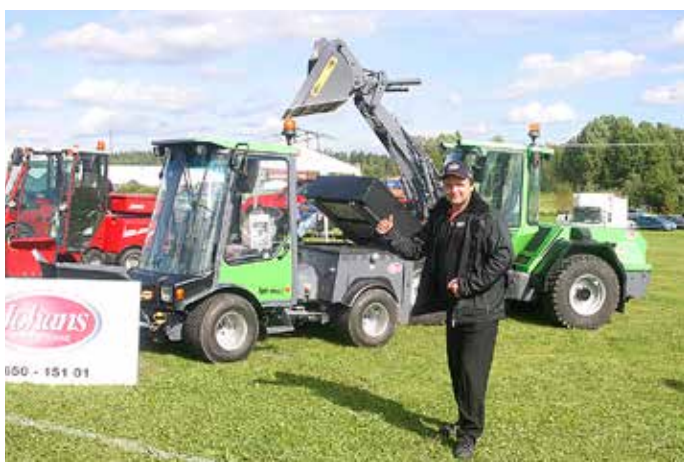
I Ventrac s monter kunde Mathias Nilsson och Anders Pettersson från Lapab Maskin visa nya uppgraderade modeller av den här välrenommerade redskapsbäraren. Bland de nya detaljerna märks motorer från Kubota, nytt elsystem, serviceluckor på sidorna, enklare montage av sandspridare m.m.
