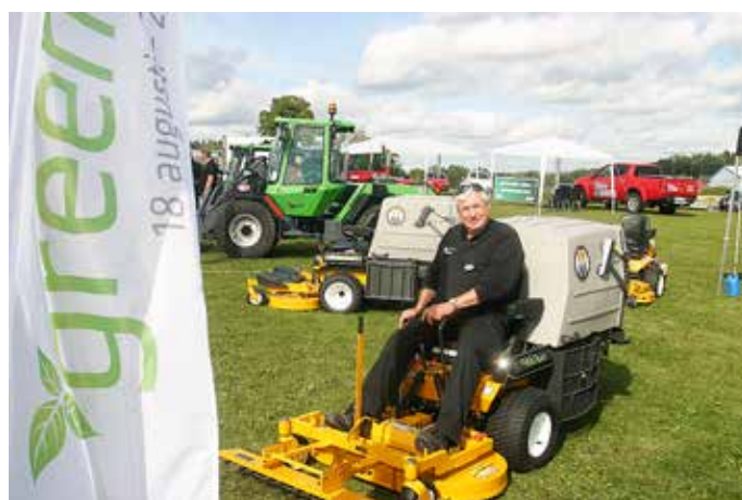
Per Holmgren från Walker Sverige visar nya Walker med tvåcylindrig vattenkyld och direktinsprutad miljömotor på 31 hk. Maskinen, som har 3 års garanti, uppfyller de stränga miljökraven enligt EFl-standarderna.
