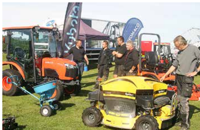
Mats Axelsson på Svenningsens visar här en ny modell från Kubota, B2650. Bland nyheterna märks hytt utan mittstolpar, mindre kardantunnel m.m.
