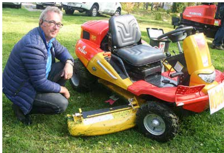
Jörgen Svensson på Bengt Bergs presenterade den här nyheten från Canycom : slagklippare med patenterat knivsystem, lätt åtkomligt från båda sidor. Fyrhjulsdrift via kardan, inga remmar som kan gå av. Klippbredd: 97 cm.
