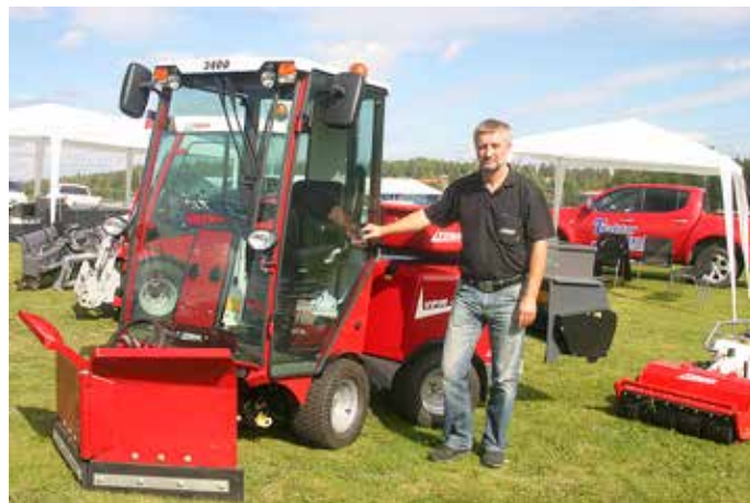
Timans representant Birger Pedersen visade modell VPM 3400 , en liten smidig redskapsbärare som bland annat kan förses med klippdäck och sopsug. Chassit är fjädrat som en bil och hytten är gummidämpad. Ljudnivån är extremt låg, vilket sammantaget med komforten ger en behaglig arbetsmiljö. 190 maskiner finns redan ute i arbete på marknaden.
