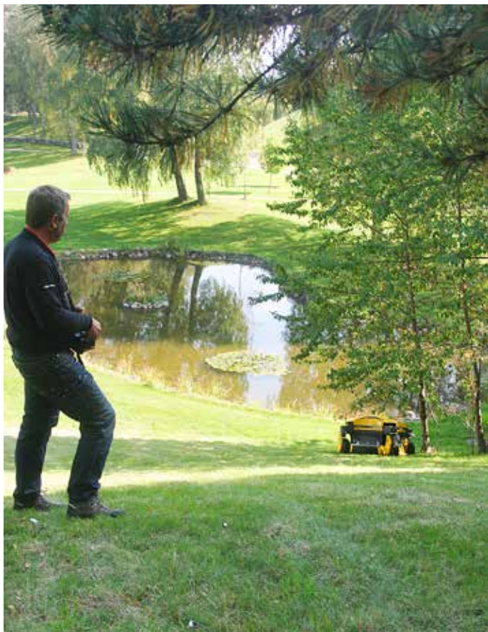
Mats Axelsson på Svenningsens demonstrerade hur fjärrstyrda Spider lätt klarar att klippa i starkt lutande slänter – utan att utsätta föraren för fara. Den klarar upp till 55 graders lutning, och tack vare aluminiumchassit bli vikten så låg som 325 kilo. Fördelat på fyra hjul betyder det lågt marktryck. Arbetshastighet: upp till 7 km/tim.
