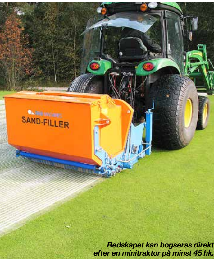
Det bortskurna materialet samlas upp och spåren fylls med sand i ett enda arbetsmoment.
