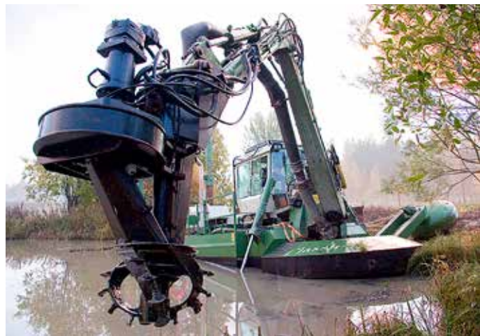
Watermaster är en universalmaskin för vattenbyggnad.
