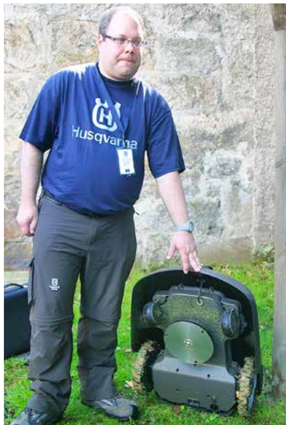
Herbert Wettels från Husqvarna i Tyskland visar den specialutvecklade tallriksrotorn på Husqvarnas självgående gräsklippare Automower. Konstruktionen ger bra klippresultat och hög säkerhet.
