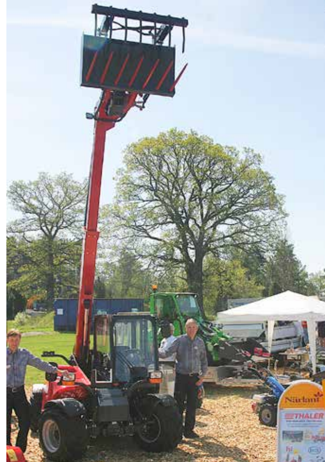
Närlant presenterade flera nyheter. Bland dem Thaler 48T18 , en krabbstyrd teleskopplastmaskin med pendlande bakaxel och styrning på alla fyra hjulen. Maskinen kombinerar maximal smidighet med hög lastkapacitet och stabilitet, enligt Anders Nilsson och Erik Zetterman på Närlant.
