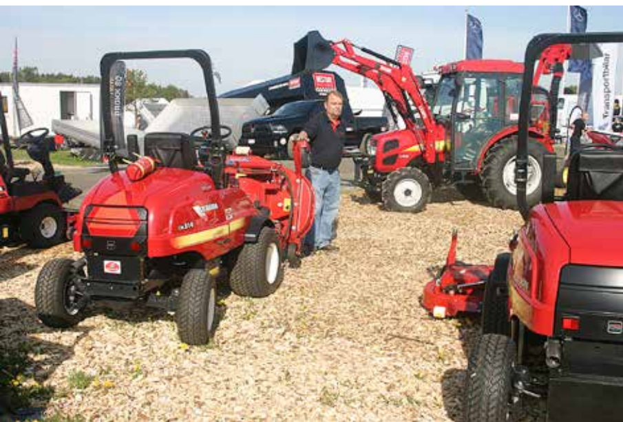
Håkan Mattsson på Mattsons maskin visade uppdaterade Shibaura CM 314 och 374 med hydraulisk klippdäckslyft samt CM 244 med uppsamlare och fyrhjulsdrift. Transporthastighet: 28 km/tim.
